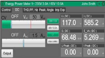
AC/DC-Quellen mit einer umschaltbaren Ansicht mit den DC-Werten.
