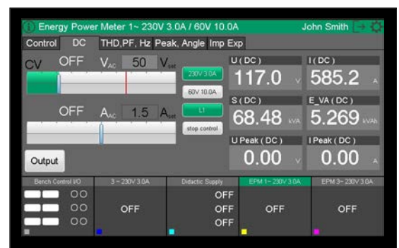
Die AC/DC-Quelle mit dem MF-Leistungsmessgerät um auch die DC-Werte messen und anzeigen zu können.
