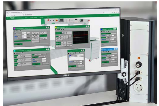
Komplette Überwachung und Fernsteuerung der Schülertische mit der BenchControl Central KP oder EP mit angeschlossenem, externen Touch-Monitor.
