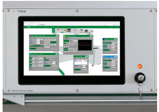
Komplette Überwachung und Fernsteuerung der Schülertische mit der BenchControl Central MP mit eingebautem Touch-Monitor.
