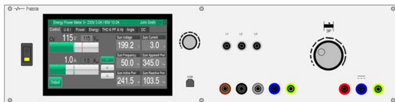
Variable AC/DC-Quelle 3phasig (2EP) mit 7" Display
