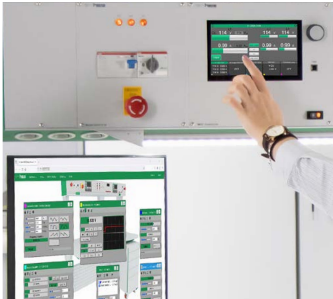
Auslesen und fernsteuern der IMOD Geräteserie mit der Software IMODdesktop und einem PC oder Laptop.
