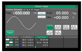
Function Generator 0,1 Hz - 200 kHz
