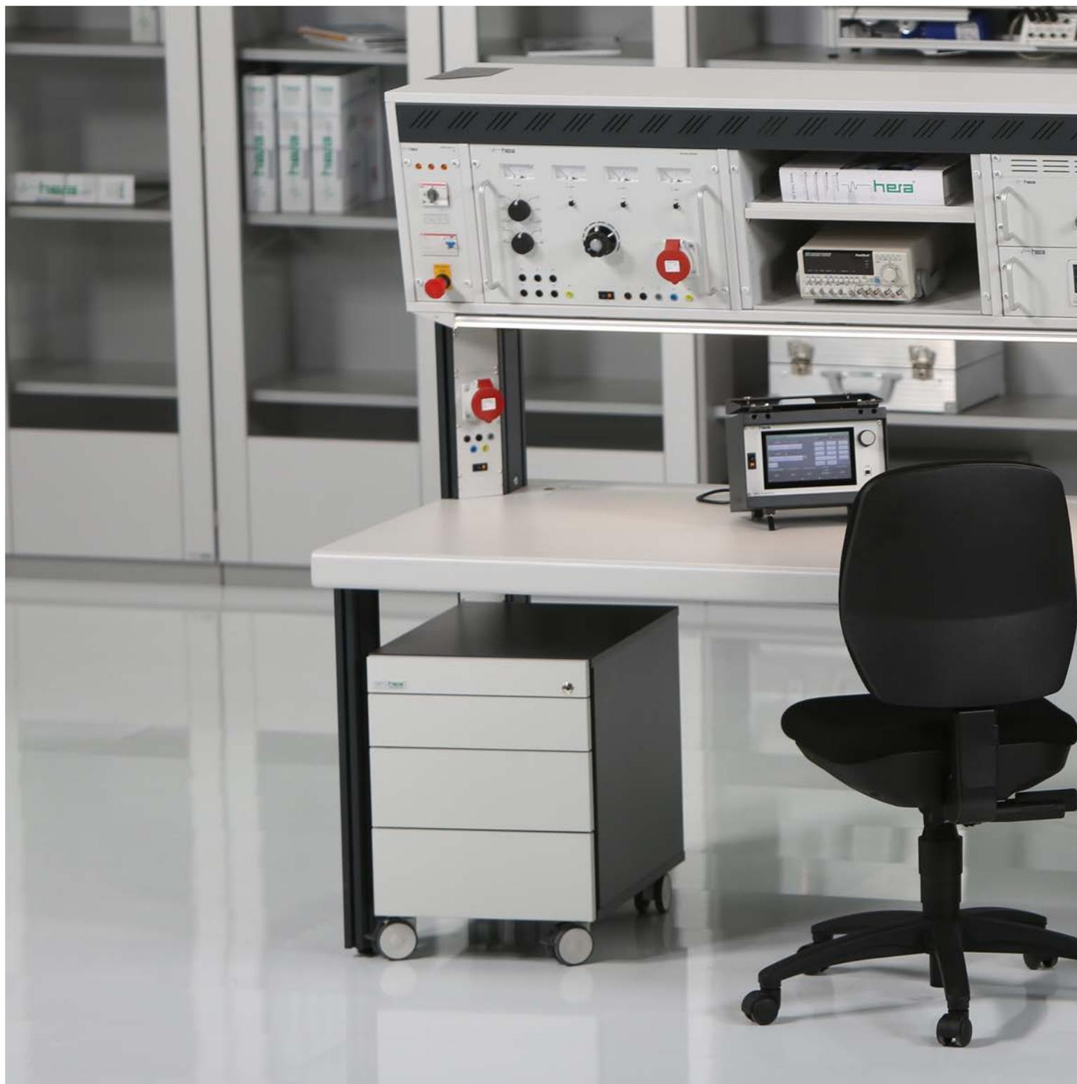
Durch Lüftungseinsätze in der Blende sowie auch im Boden des Aufbaus wird sichergestellt, dass selbst bei direkt an der Wand platzierten Aufbauten kein Wärmestau auftreten kann.
