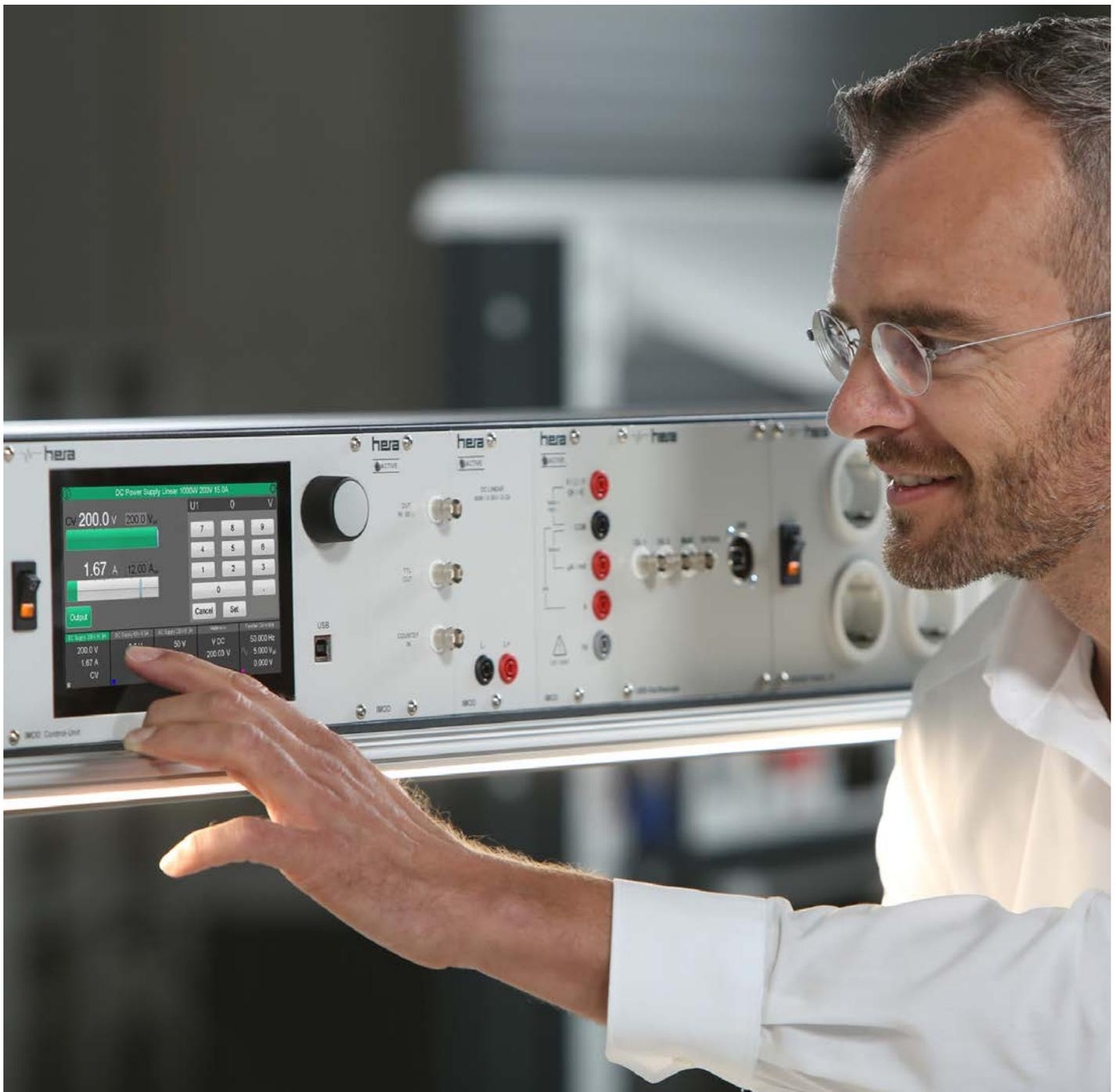
Durch die drei räumlich getrennten Einheiten kann die Anzeige ergonomisch mittig und die Ausgänge seitlich in den Energiesäulen positioniert werden. Schwere Function-Units wie beispielsweise AC-Quellen können platzsparend unter dem Tisch montiert werden.
